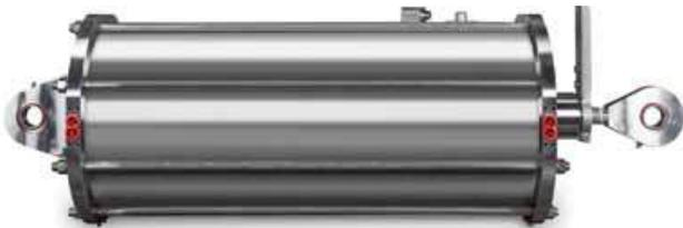
SC è una linea completa di attuatori pneumatici lineari progettata e costruita per dispositivi di controllo quali ammortizzatori, serrande e ventilatori. STI è in grado di realizzare cilindri interamente in acciaio inox, così da poter lavorare anche in condizioni climatiche estreme (nella foto un cilindro diametro 330 corsa 700 con pannello di controllo per il progetto HAMMERFEST in Norvegia).
