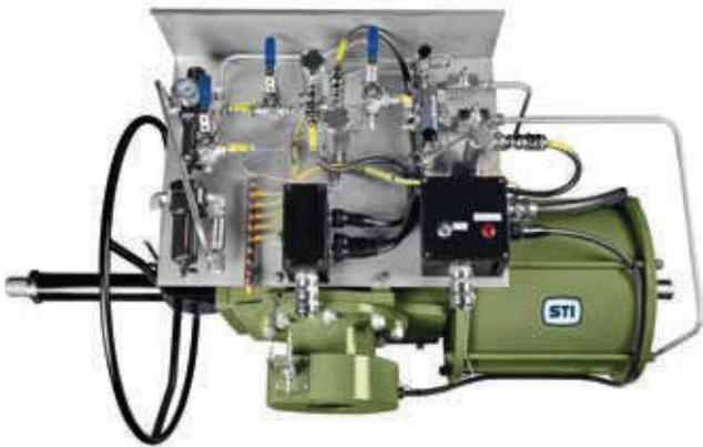
Gli attuatori a quarto di giro della serie RTC & RTQ sono realizzati in acciaio al carbonio, disponibili sia nella versione pneumatica per pressioni fino a 12 Barg che idraulica per pressioni fino a 350 Barg. Una versione speciale in acciaio inox è disponibile per operare in condizioni climatiche estreme.
